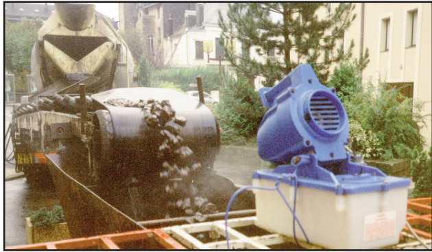
(B) Système de désinfection de la pouzzolane.
