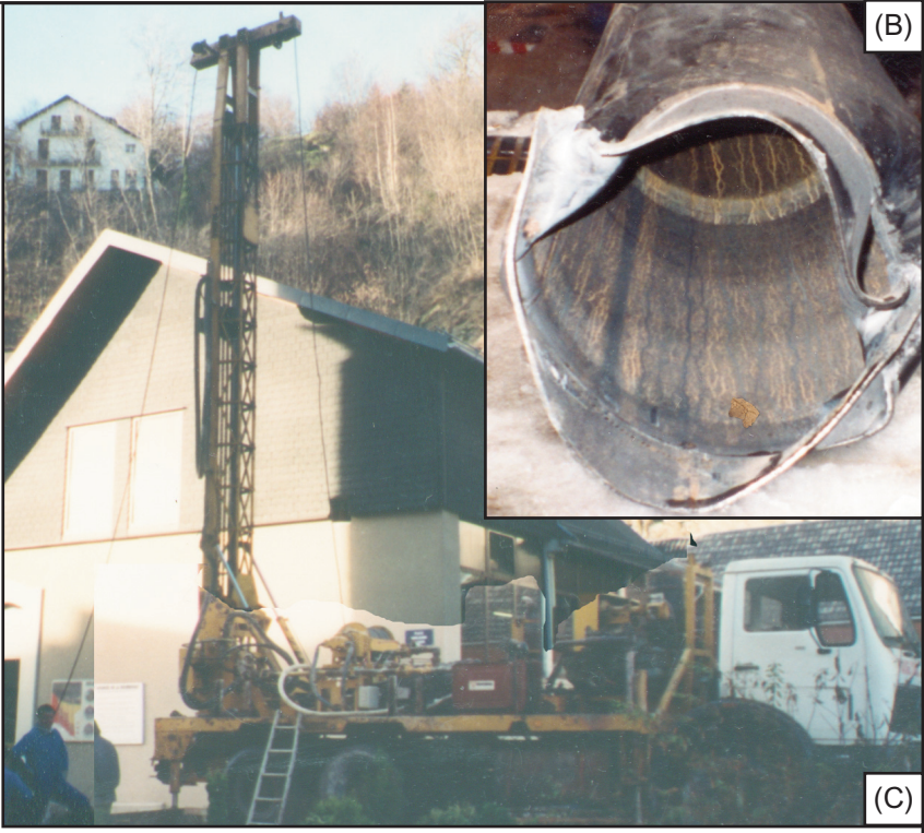
(B) Partie inférieure de la colonne après sa chute. (C) Machine de forage installée afin de permettre le découpage et l'extraction d'une section de l'ancienne colonne abîmée par la chute de la nouvelle colonne.
