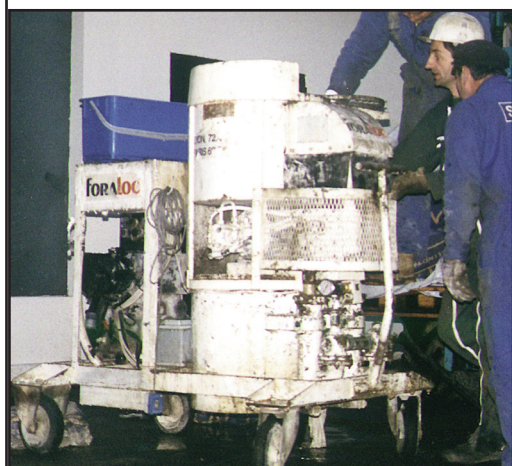
(F) Machine à fabriquer et injecter du laitier en forte quantité.
