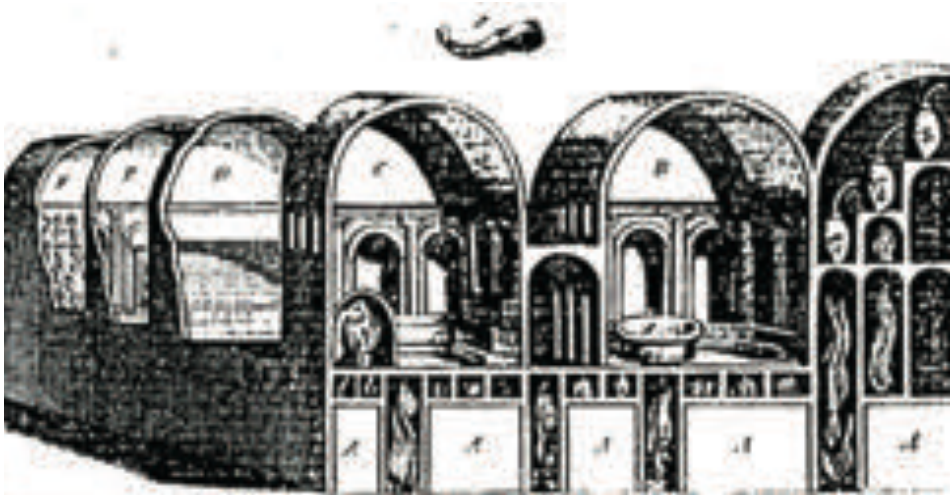
Coupe d'un bain antique d'après une peinture trouvée dans les bains de Titus à Rome (édition de Vitruve) A : Fourneau ; B : Caldarium ; C : Laconicum ; D : Tepidarium ; E : Frigidarium
